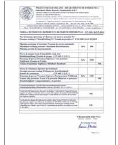
ПРОТОКОЛ ИСПЫТАНИЙ Сертификат лаборатории MRT (Миланский Политехнический университет) об испытаниях: герметичности, максимального рабочего давления, сопротивления и соответствия требованиям проектных расчетов в соответствии со стандартом EN 442-1 и EN 442-2. TEST REPORT Certificate of Laboratory MRT (Politecnico di Milan-Italy) on following tests: hydraulic pressure test, maximal operating pressure, endurance and conformity of radiator to the drawing's dimensions according to the standard EN 442-1 e EN 442-2.
